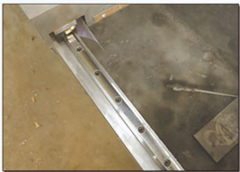
High precision straight square rail. 高精度直线方轨。
