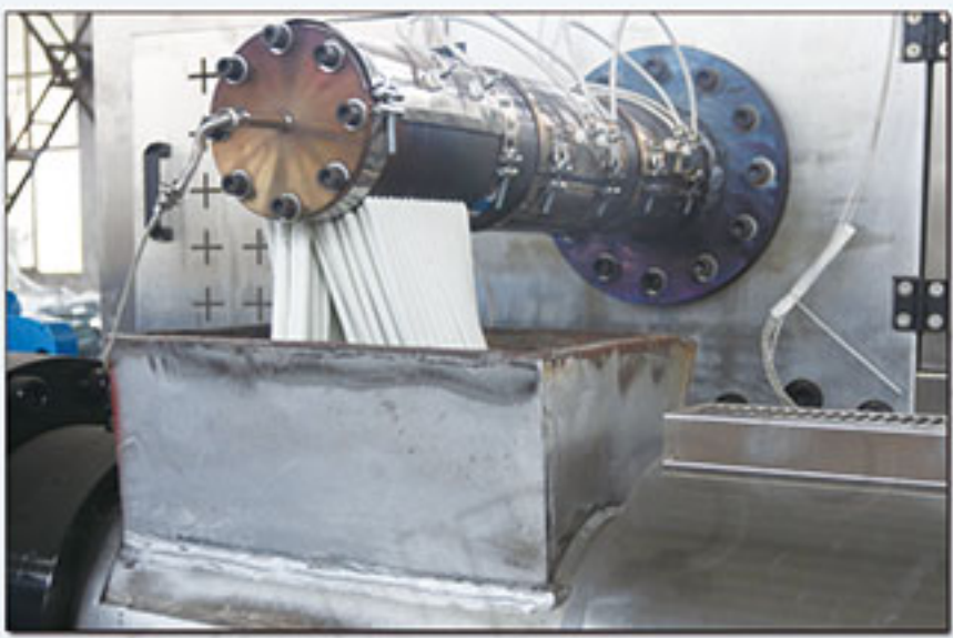
母机排料排气口 Mother Extruder Die Head
