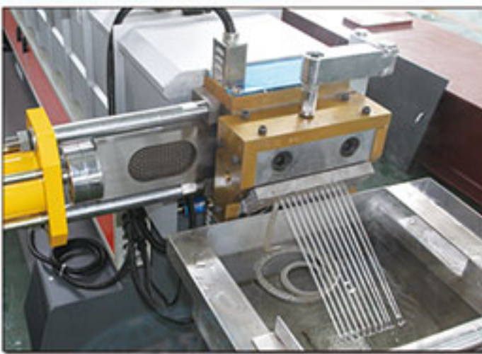
Plastic Strand Die Head 拉条模头
